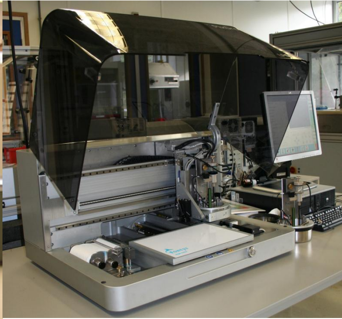
5.4 Inktjet printer voor OLED's
