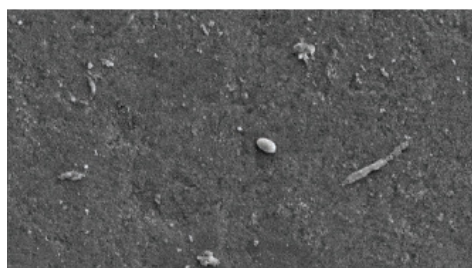
Biofilme da placa tratada em um teste de laboratório.
