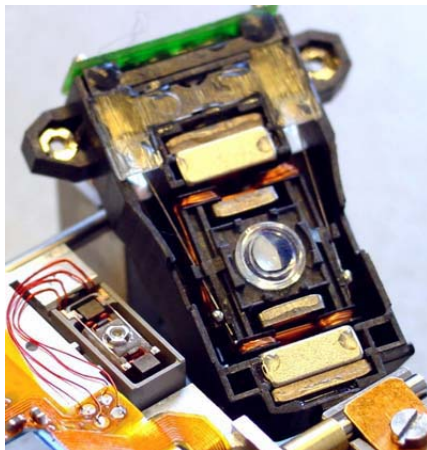
figuur 16. Een tracking actuator uit een dvd-speler
