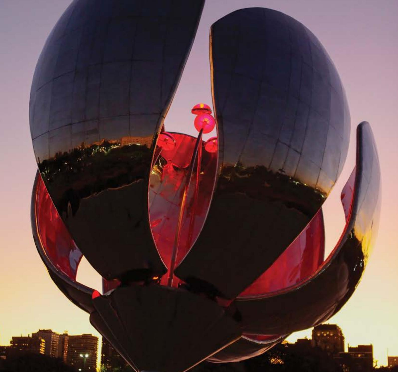
Las luminarias Philips ColorReach Powercore se instalaron en la base de cada pétalo y en el centro de la flor para bañar de luz en forma uniforme el interior de la obra. Estos proyectores RGB LED de alto rendimiento para uso en exterior permiten iluminar edificios altos, puentes y estructuras icónicas con cambio de color y con la posibilidad de personalizar las características del haz de luz. En este caso, se aplicaron lentes de 23° para lograr uniformidad.
