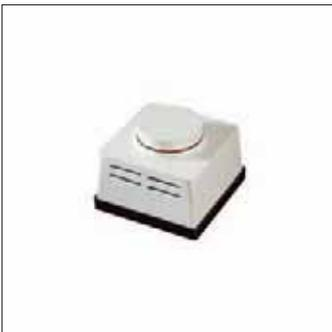
Potentiomètre rotatif manuel avec microrupteur pour montage apparent. Associé à un ou plusieurs ballasts électroniques HF à régulation 1-10 V, régulateurs électroniques de lumière ou contrôleurs Trios, il sert à contrôler le niveau lumineux de lampes fluorescentes, halogènes ou incandescentes.
