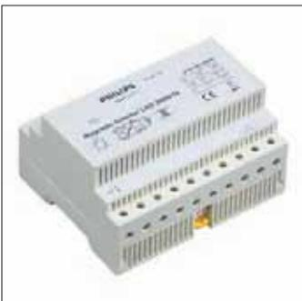
Régulateur de lumière pour lampes à incandescence, lampes halogènes haute tension et lampes halogènes basse tension à transformateurs électroniques. À utiliser en combinaison soit avec une unité TRIOS, un contrôleur LMM (1-10V) ou LPS100. Charge maxi. de 1000 VA.
