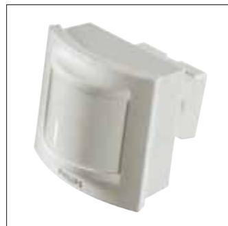
Détecteur de mouvement infrarouge passif pour montage de grande hauteur (hauteur d'installation jusqu'à 15 m), équipé d'une temporisation réglable (jusqu'à 35 minutes). Peut être utilisé avec toutes les unités de commande MDU. Un étrier de montage spécial (ZTX400 MB-MDU) est disponible pour encliquetage du détecteur de mouvement
