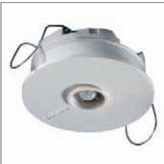
Détecteur de mouvement compact et sophistiqué avec délais d'extinction variable via un micro-interrupteur et pouvant être partiellement masqué pour limiter la couverture. Le capteur est alimenté via un câble enfichable modulaire (RJ12) supplémentaire le reliant à un contrôleur d'éclairage. Le capteur convient au montage tant
