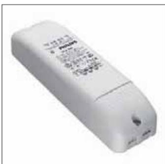
Transformateur électronique 150 VA réglable très basse tension. 230/240 V - 12 V - 50/60 Hz. Dimensions très compactes. Gradation bord arrière - bord d'attaque. Protégé contre la surchauffe, les surcharges et les courts-circuits. Installation Prêt à l'emploi - rapide à installer. Borne serre-fils double sur le circuit primaire 230 V.
