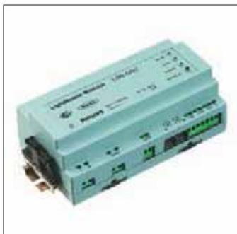
Module LCM de gestion d'éclairage pour commande Dynamic Ambience. Ce contrôleur peut être employé seul ou comme partie d'un système LMM et maintient 4 rythmes d'ambiance dynamique pour différents types de luminaires Philips Dynamic Lighting. Il peut commander 64 ballasts (en général 32 luminaires) Pour de plus
