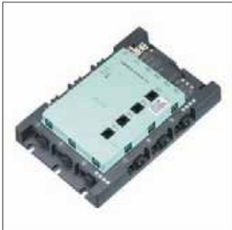
Module LCM de gestion d'éclairage à commutation & régulation (1-10V) à 9 sorties, 4 interfaces capteur (cellules photoélectriques, détecteurs de mouvement et récepteurs infrarouge [IR] et 4 entrées pour interrupteurs muraux standard. Toutes les entrées et les sorties ainsi que les connexions réseau sont des connecteurs mâle-
