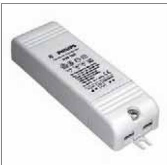
Transformateur électronique 105 VA réglable très basse tension. 230 V - 240 V - 12 V - 50/60 Hz. Dimensions très compactes. Gradation bord arrière - bord d'attaque. Protégé contre la surchauffe, les surcharges et les courts-circuits. Installation Prêt à l'emploi - rapide à installer. Charge mini./maxi. 35 W/105 W. Distance maximum à la
