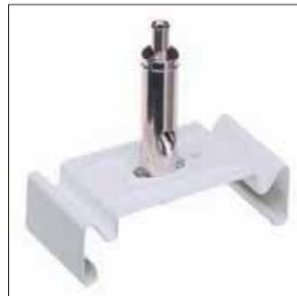
Étrier de suspension pour rails TTX400/410 par câble en acier M 1.8. Mécanisme d'agrafe intégré permettant le réglage facile, sans outil, de la hauteur de montage. Le câble d'acier peut être commandé séparément avec l'accessoire ZTX400 SW1.8-10000
