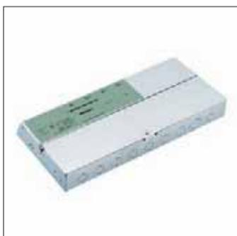
Module de gestion d'éclairage à 4 sorties sans tension, commutation & régulation (1-10V) permettant la commutation de circuits séparés de même phase. Il existe 2 alimentations permanentes pour luminaires de secours, également sans tension mais commutées simultanément. Le 4LS à 4 interfaces capteur (cellules
