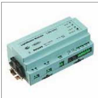
Module de gestion d'éclairage DALI dans un boîtier rail DIN à 1 sortie DALI . Ce contrôleur peut commuter et régler jusqu'à 64 dispositifs DALI. Les dispositifs DALI peuvent être commandés séparément ou en groupes. L'unité dispose d'entrées pour capteurs et interrupteurs mais est prévue pour fonctionner en
