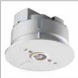
La version avancée d'Occuswitch LRM1080 est un détecteur de mouvement à interrupteur intégré. Il éteint l'éclairage lorsqu'une pièce ou un espace sont inoccupés, économisant ainsi jusqu'à 30% de consommation d'électricité. Occuswitch peut commuter toute charge jusqu'à 6 A et commander une surface de bureau
