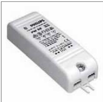
Transformateur électronique 60 VA réglable très basse tension. 230 V - 240 V - 12 V - 50/60 Hz. Dimensions très compactes. Gradation bord arrière - bord d'attaque. Protégé contre la surchauffe, les surcharges et les courts-circuits. Installation Prêt à l'emploi - rapide à installer. Charge mini./maxi. 10 W/60 W. Distance maximum à la
