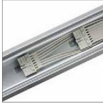
Rail standard TL5 4MX656 et TL-D 4MX056 Maxos avec deux câbles en nappe 7 connecteurs (2x7x1,5/2x7x2,5) ; pour créer différentes zones d'éclairage avec gradation ou éclairage de secours séparé
