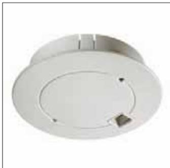
Cellule photoélectrique destinée au montage de grande hauteur (7,5 m de haut). Destiné à une utilisation avec la commande Linesense (ZTX400 MDU-D). Un étrier de fixation est fourni. Le capteur est connecté à l'unité de commande avec un câble de connecteur enfichable modulaire (RJ-12).
