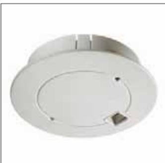
Cellule photoélectrique destinée au montage de grande hauteur (environ 7,5 m de haut). Destiné à une utilisation avec la commande Linesense (ZTX400 MDU-D). Un étrier de fixation est fourni. Le capteur est connecté à l'unité de commande avec un câble de connecteur enfichable modulaire (RJ-12)
