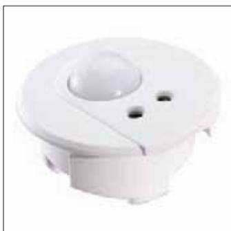
Ce multicapteur monté au plafond renferme un récepteur IR, une cellule photoélectrique constante qui mesure la lumière réfléchie d'en bas de l'appareil, et un capteur d'occupation PIR. Le multicapteur est fourni avec un restricteur d'angle 40° pour la cellule photoélectrique. La minuterie du capteur d'occupation PIR peut être
