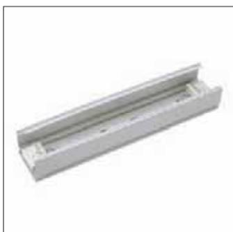
La boîte d'alimentation en milieu de ligne permet le raccordement secteur au milieu d'une ligne lumineuse. Elle comprend deux borniers à 7 pôles pour l'alimentation secteur. Elle s'utilise dans le cas de très longues lignes lumineuses pour réamorcer l'alimentation dans les deux sens. Utiliser la même boîte d'alimentation en cours de ligne pour le rail TTX400 avec câble interne en nappe à 5 ou 7 connecteurs.
