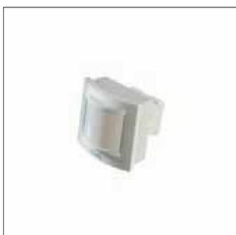
Détecteur de mouvement mural, infrarouge, passif pour solutions à économie d'énergie en applications d'éclairage intérieur. Il détecte le plus léger mouvement dans un angle de 90° (portée maximale de 15 m à une hauteur de montage de 2,1 m) Retard d'extinction réglable jusqu'à 35 minutes. Branchements électriques
