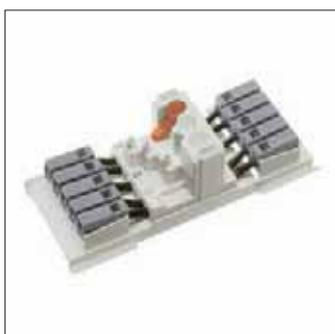
Connecteur à 5 pôles pour unité électrique sur rails TTX410 non câblés. Utiliser le même connecteur comme bornier supplémentaire pour le rail TTX400 précâblé pour la connexion à l'éclairage de secours ou à la régulation de l'éclairage. Montage en fond de rail par encliquetage
