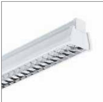
GMX555 Réflecteur(s) TL5 multifonctions et optique OLC GGX555 en aluminium grand brillant de grande qualité avec grille de défilement à ventelles 3D (C6)
