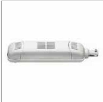
Alimentation à transformateur pour connexion électrique directe 12 V au rail. Connexion au primaire 230 V - 240 V évalué pour 150 VA, elle délivre 11.8 V/12.5 A maxi avec protection contre court-circuits et surcharges. Fixation sur toutes surfaces avec 2 vis.
