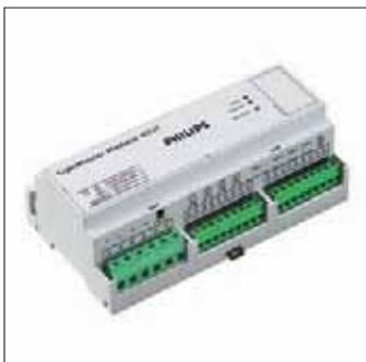
Unité rail DIN à 4 sorties séparées (Commutation & Régulation [1-10V]) susceptibles de commuter une charge de 5 A chaque pour commander les luminaires directement ou via des contacteurs dans l'armoire pour commuter des charges d'éclairage supérieures.
