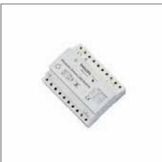
Régulateur de lumière pour lampes à incandescence, lampes halogènes haute tension et lampes halogènes basse tension à transformateurs électroniques. Charge maxi 1000 VA, à utiliser en combinaison soit avec une unité Trios, un contrôleur LightMaster Modular (1-10 V) ou LPS100.
