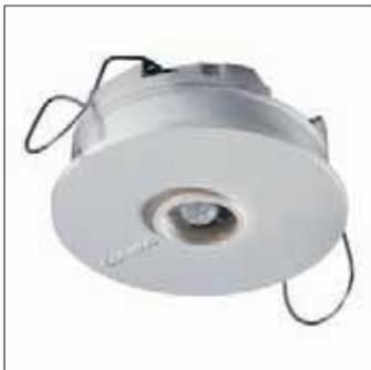
Détecteur de mouvement compact à utiliser pour étendre la zone de détection des luminaires intégrant ActiLume. Le capteur est connecté au bus DALI du luminaire Actilume et ne requiert pas d'alimentation externe. Le capteur convient au montage tant encastré qu'apparent. Hauteur de montage entre 2,5 m et 3,5 m.
