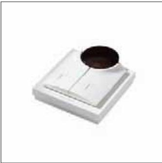
Télécommande infrarouge à deux touches pour montage mural et de table. L'unité peut être employée dans les applications Trios. La fonction réelle des deux grosses touches se sélectionne grâce à un micro-interrupteur dans le compartiment à piles. Un micro-interrupteur sert aussi à la sélection de l'adresse de groupe.
