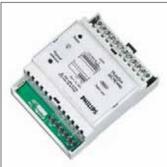
L'unité d'entrée offre 8 entrées à contact sec. Elle dispose de trois modes de fonctionnement, dont deux imitent les interfaces à bouton-poussoir utilisant des contacts momentanés. Le troisième mode est destiné aux contacts à fermeture continue. À l'instar des autres commandes de la gamme MultiDim, l'unité d'entrée
