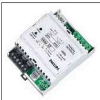
Le convertisseur 1 - 10V est conçu pour le contrôle des ballasts HF-R. Ceci permet d'assurer la compatibilité des systèmes MultiDim avec les systèmes existants ainsi qu'une intégration aisée. Le convertisseur peut assurer la commutation d'un maximum de 12 ballasts HF-R. Le signal analogique 1 - 10V et le signal numérique DSI peuvent commander 50 ballasts HF-R.
