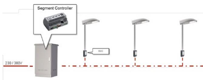
dans ce point lumineux. Les commandes émanent de l'OLC qui les donne au driver et rassemble des informations de ces points lumineux. La communication entre l'OLC et le Contrôleur de Segment a lieu par le réseau d'alimentation. Il n'y a donc pas besoin de câbles supplémentaires et le système est facile à mettre en place.
