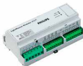
Unité sur rail DIN avec 4 sorties séparées (commutation et régulation [1-10 V]) chacune capable de commuter une charge de 5 A pour contrôler les luminaires directement ou via les contacteurs dans l'armoire pour commuter des charges d'éclairage plus élevées.
