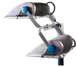
OptiVision peut aussi être monté au-dessus ou en dessous de la traverse en inversant l'étrier. Cela permet de placer plusieurs projecteurs sur chaque mât.
