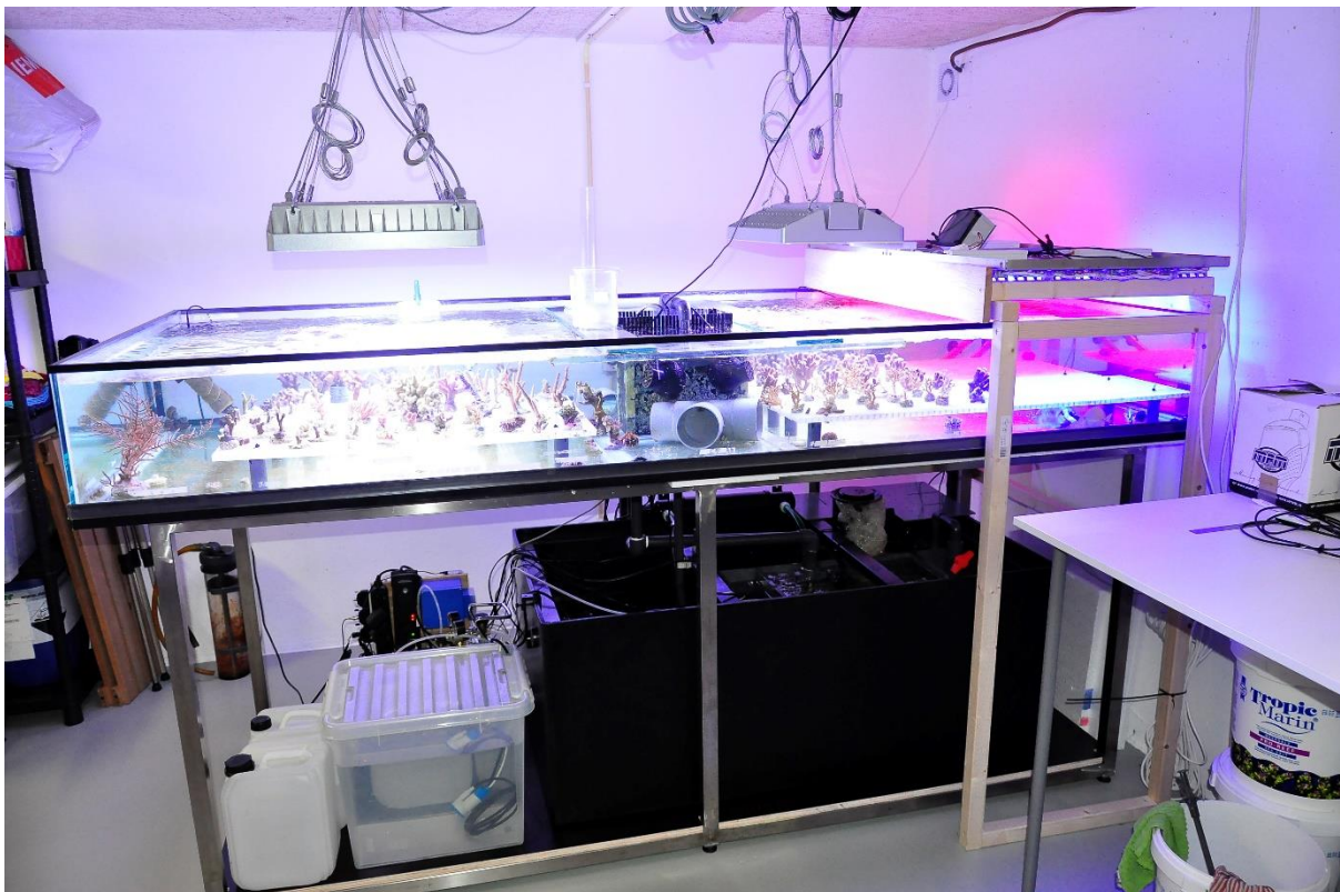
Réservoir expérimental principal de CORALAB équipé d'unités LED bleues et rouges côté droit du réservoir.
