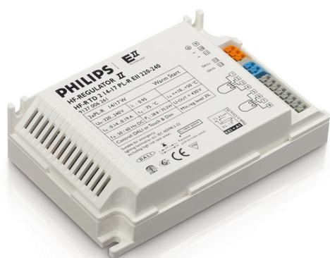
Ballast électronique intelligente haute fréquence pour la gradation, utilisant DALI (interface d'éclairage à adressage numérique conformément à IEC62386) ou le protocole à bouton-poussoir Touch and Dim pour lampes fluorescentes (compactes). Propose le mode couloir, programmable avec Philips MultiOne. Le fonctionnement haute fréquence permet d'améliorer la qualité de lumière et la durée de vie de la lampe. Anticipe la réglementation à venir en répondant aux exigences A1BAT.
