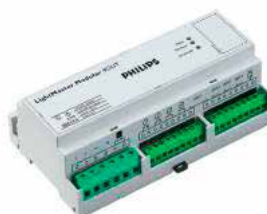
Unité sur rail DIN avec 4 sorties séparées (commutation et régulation [1-10 V]) chacune capable de commuter une charge de 5 A pour contrôler les luminaires directement ou via les contacteurs dans l'armoire pour commuter des charges d'éclairage plus élevées.
