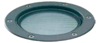
Glas met lineaire bundelspreider (LBSP) Fijngeribbeld glas om de bundel horizontaal of verticaal te verbreden
