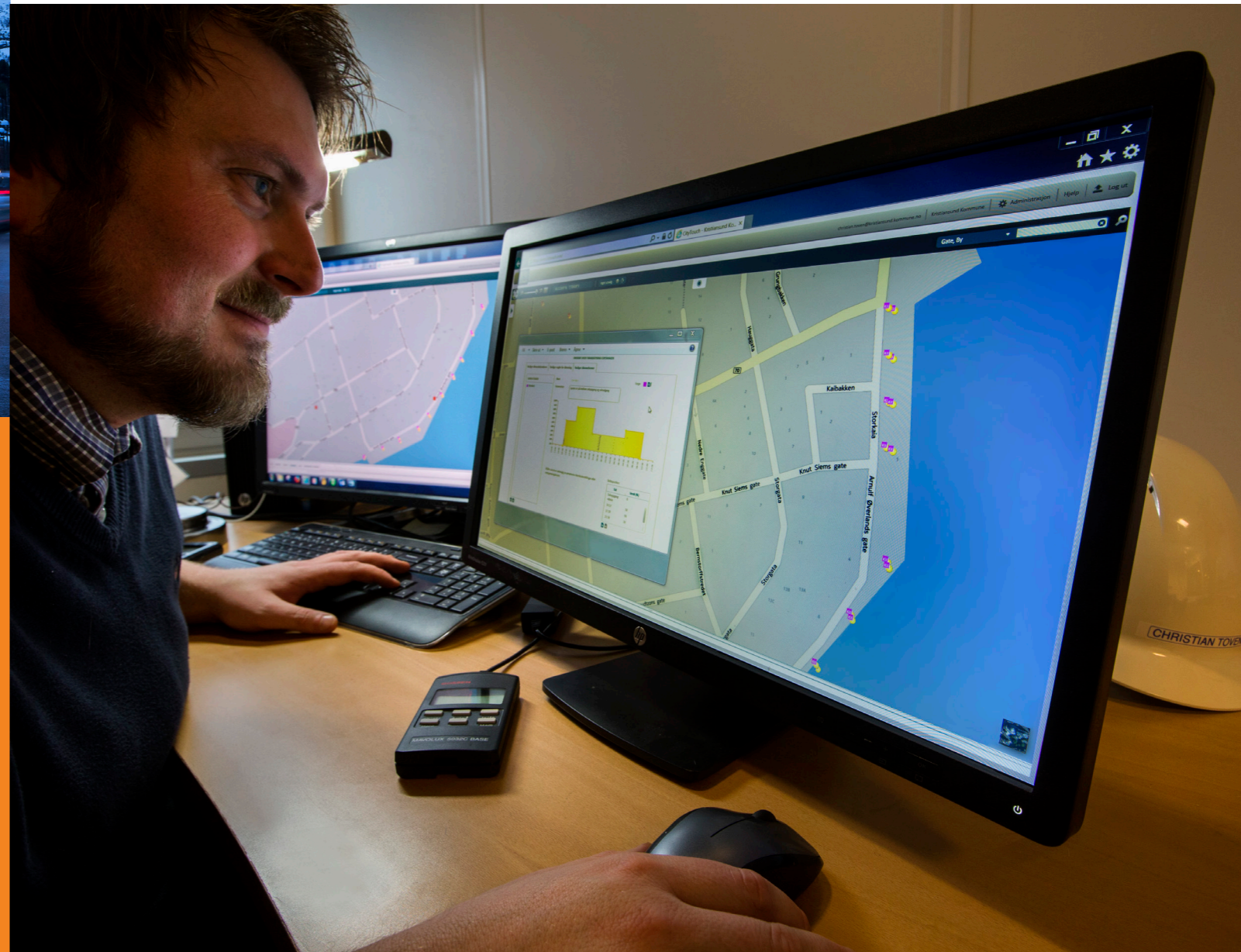
Citytouch-järjestelmä yhdistää kaikki julkisen valaistusverkon CityTouch-valopisteet yhteen, jolloin niitä voidaan helposti ohjata ja seurata suoraan tietokoneen työpöydältä.
