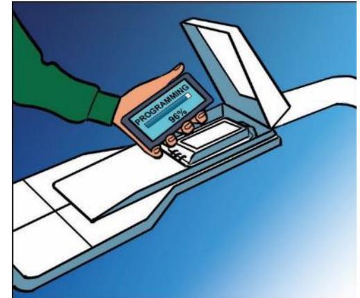
Vous avez maintenant le driver de rechange, et il en fait peut-être pas celui d'origine, mais une version compatible. Maintenant que vous venez de l'installer, il a besoin d'être reprogrammé avec les paramètres d'origine comme, l'intensité LED, la courbe de gradation etc. Avec l'application, il est si facile de lire le service TAG directement à partir de celle-ci, mettez votre smartphone sur le driver, pressez la touche «programme», et vous avez terminé!
