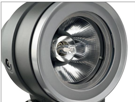
ZoomFokus wurde speziell für Decoflood<sup>2</sup> DVP626 und DVP627 entwickelt. Mit einer Stellschraube außen am Gehäuse kann der Ausstrahlungswinkel einfach und bei eingeschaltetem Scheinwerfer verändert werden. Erstmals kann so der gewünschte Lichteffekt einfach und flexibel direkt vor Ort eingestellt werden.
