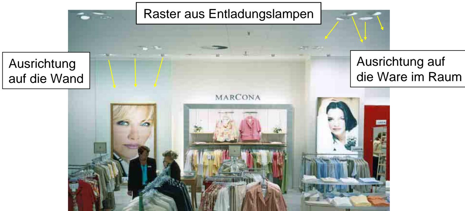
Bei der modernen Warenhausbeleuchtung setzen Lichtplaner auf hohe Grundbeleuchtungsstärken von 800 – 1000 lx, helle Räume, um indirekte Lichtanteile optimal zu nutzen, und ausrichtbare Downlight-Raster\*.
