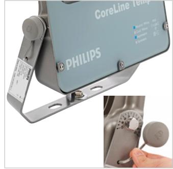
Einfache Befestigung mit einem verstellbaren Montagebügel: Neigungswinkel: -120^\circ bis +120^\circ (präzise einstellbar durch Skala am Bügel); 360^\circ drehbar bei Einpunkt-Montage
