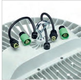
Einfache Montage mit einem (PSU) oder zwei (PSD) aussenliegenden, elektrischen Steckanschlüssen (IP65) – vorverdrahtet mit Stecker (Buchsen beiliegend) und Montagehaken zur Einpunkt-Befestigung
