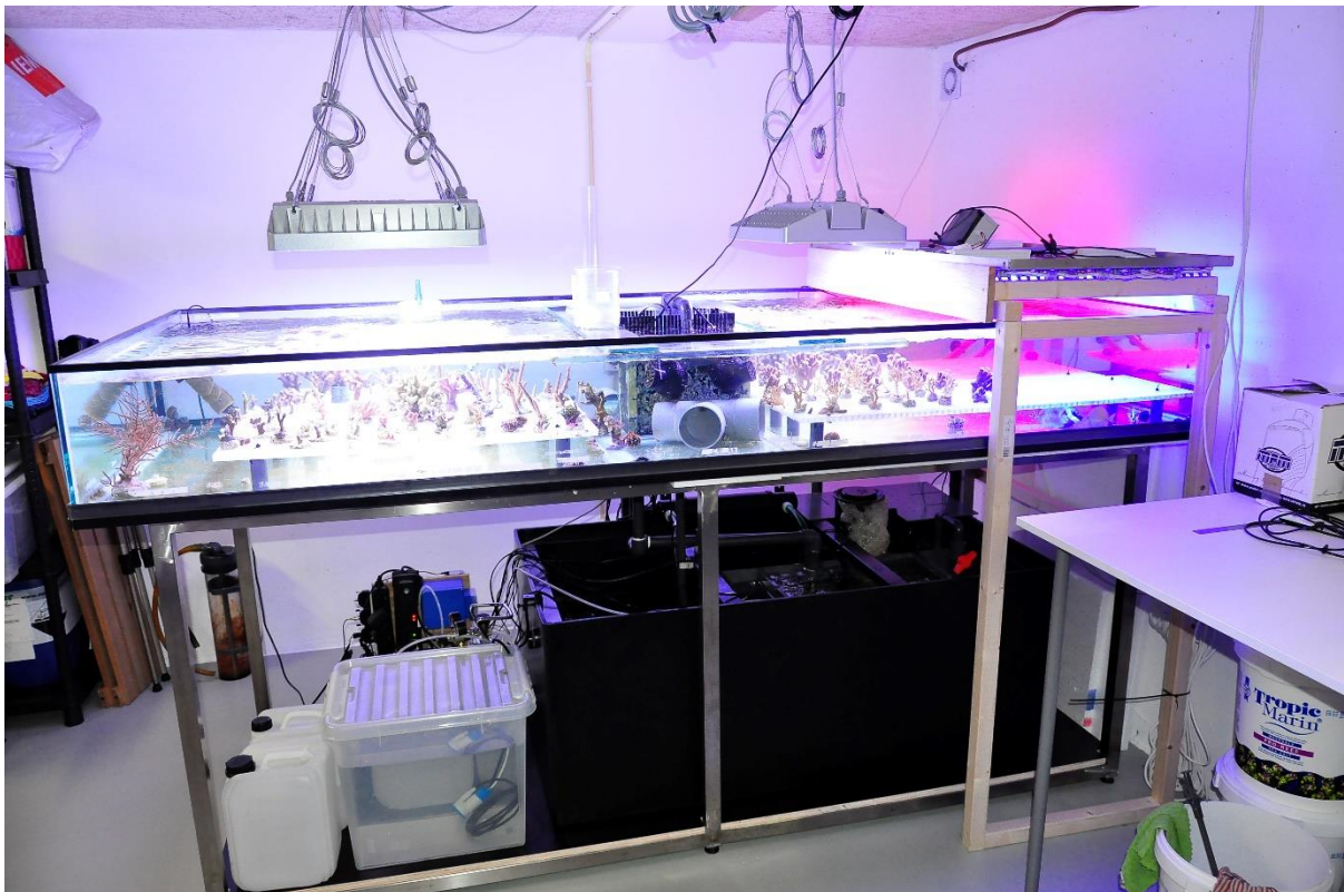
Das Haupt-Experimentierbecken von CORALAB, mit blauen und roten LED-Einheiten an der rechten Beckenseite.
