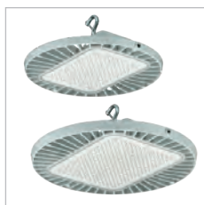
CoreLine Hallenleuchte BY120P G3 mit 10.500 lm (ø 379 mm) und BY121P G3 mit 20.500 lm (ø 452 mm). Beide mit breitstrahlender, rotationssymmetrischer Optik und standardmäßigem Montagehaken
