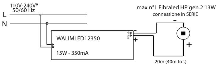
\* Verificare la tensione di ingresso supportata dagli alimentatori / Verify the input tension supported from drivers
