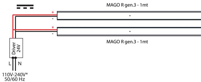
\* Verificare la tensione di ingresso supportata dagli alimentatori / Verify the input tension supported from drivers
