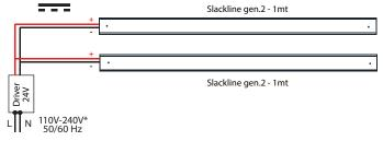
${}^*\textit{Verificare la tensione di ingresso supportata dagli alimentatori / \textit{Verify the input tension supported from drivers} \\$
