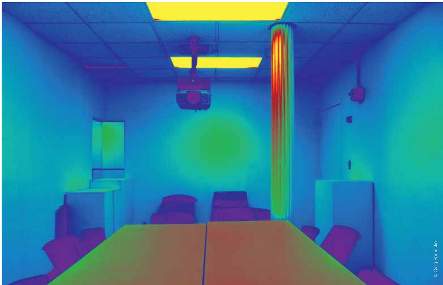
Immagine HDR di una stanza e associata mappa di luminanza in falsi colori. Si fa riferimento alla tecnica di misurazione con fotocamera digitale per catturare meglio i dati di luminanza e di conseguenza studiare in modo più preciso la percezione della luminosità..
