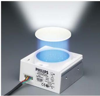
Fortimo LED DLMでは青色LEDを搭載、拡散板の下の内部空間を利用して光を十分に混合することで個々の青色LEDがもつ輝度や色味のバラつきを抑えます。そして、青色LEDから白色光への変換は黄色蛍光体を練り込んだ一枚の大きな拡散板で一括して行うため、光の立ち上がり面から、ムラのない均一でなめらかな光が得られます。
