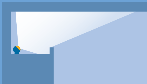
▲ 壁面最上部の外周コーブからのシーリング照明
