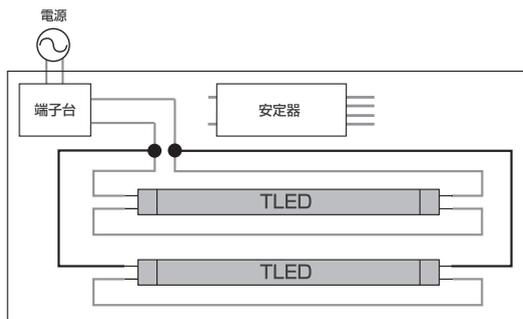
上図の配線によりランプの取り付け方向がなくなります。
