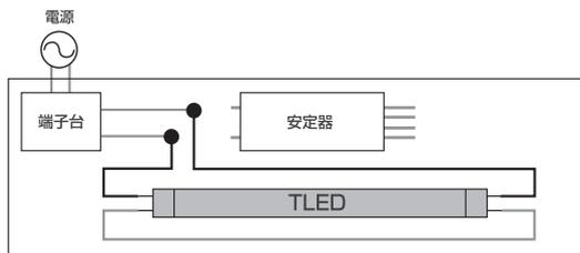
上図の配線によりランプの取り付け方向がなくなります。
