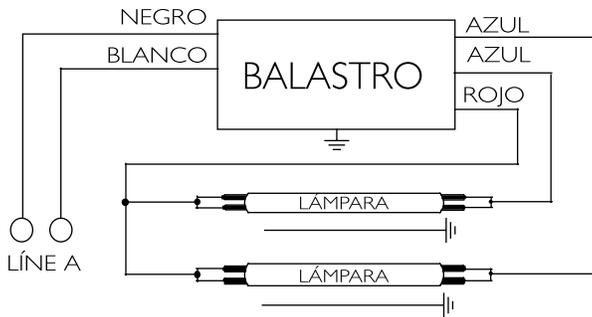
Para operar una lámpara aisle el cable Azul no utilizado a 600V
