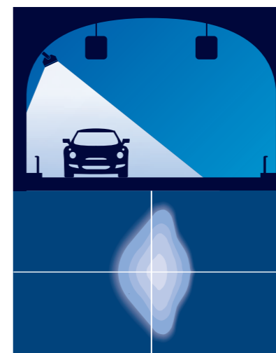
Iluminación de entrada e interior. Configuración típica central/de túnel de 2 carriles
