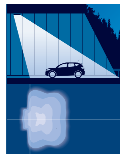
Iluminación de entrada. Configuración típica central/de túnel de 2-3 carriles
