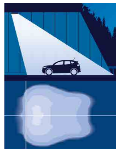
Iluminación de entrada. Configuración típica central/de túnel de 2 carriles
