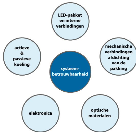
Figuur 5 – Kritische componenten van een LED-armatuur
