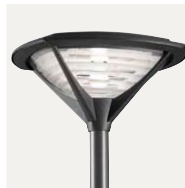
Logo (FSM/SE/ST/MT) Rotatie-symmetrische optiek met UV-bestendige kunststof design louvres. Rondom de lampbrander is een metalen anti-verblindingscherm aangebracht.
