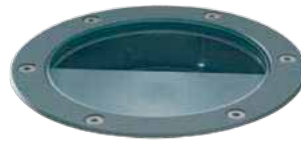
Glas, halve maan (HMG-FR) Glas, halve maan, dat ten dele mat is aan de binnenkant om de invalhoeken van de bundel op de muur te verzachten en te zorgen voor een mooie, horizontale afsnijding aan het eind
