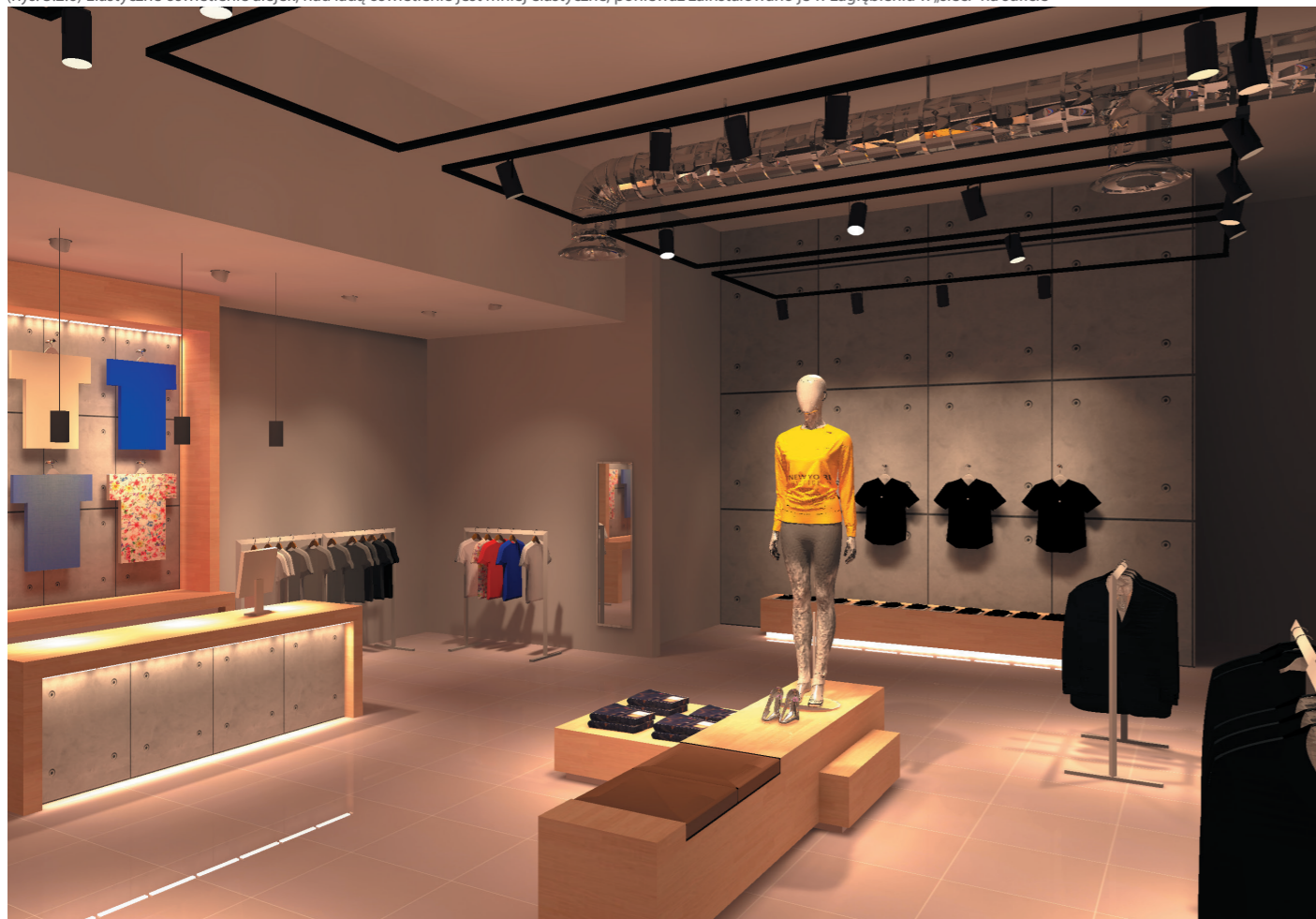
(Rys. 3.2.6) Elastyczne oświetlenie alejek, nad ladą oświetlenie jest mniej elastyczne, ponieważ zainstalowano je w zagłębieniu w „sieci” na suficie
