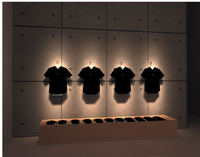
(Rys. 2.1.2) Cztery punkty na ścianie – wiązki o kącie 12° generowane przez soczewki
