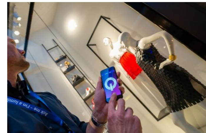
(Rys. 3.3.2) Łatwa regulacja oświetlenia wystawy sklepowej za pomocą aplikacji mobilnej
