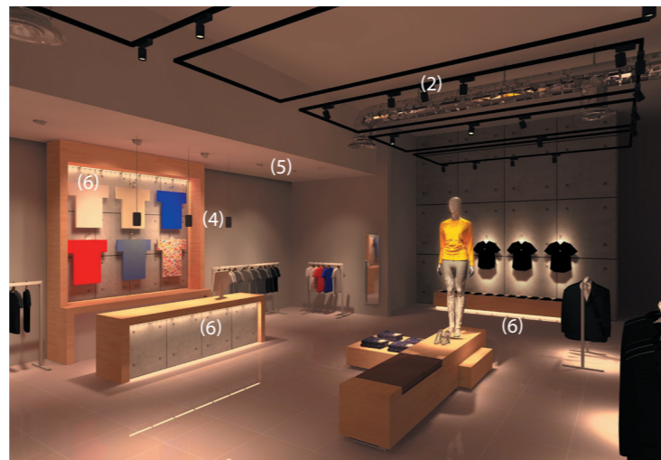
(Rys. 3.2.3) Typowe rodzaje opraw oświetleniowych i możliwości ich montażu dla uzyskania oświetlenia akcentującego
