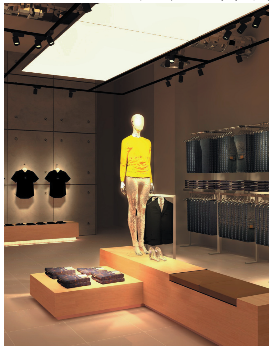
(Rys. 3.1.6) Połączenie oświetlenia ogólnego i skupionego
