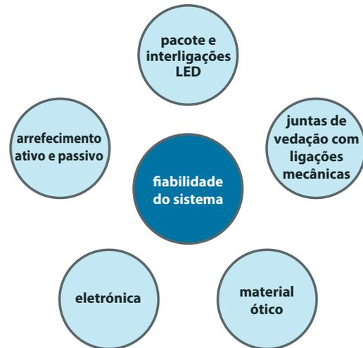
Figura 5 – Componentes importantes da luminária com tecnologia LED
