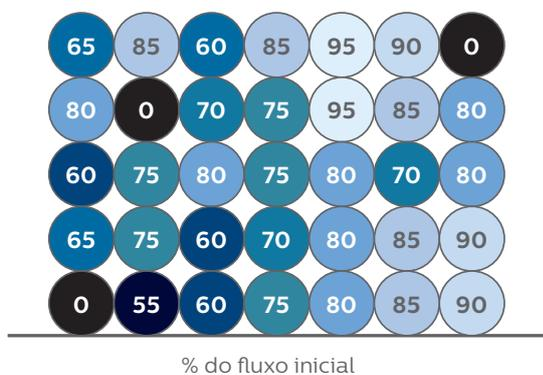
Dentro do nosso lote de amostra de produtos LED, podemos verificar que alguns falharam completa ou abruptamente. Isto pode dever-se a uma falha mecânica, a uma falha no controlador ou a qualquer outra razão que possa levar a uma falha abrupta.
