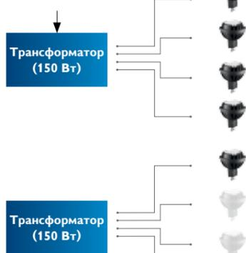
Максимальное напряжение кабеля не достигнуто, но дополнительный MR16 превысил бы максимальное напряжение системы
