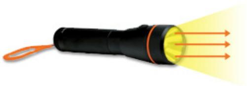
Así, la intensidad es una unidad de luz que se puede usar para especificar la cantidad, o concentración, de luz en una dirección determinada. La intensidad luminosa se define como el flujo luminoso en una dirección determinada, irradiada por unidad de ángulo sólido  $\omega$  (figura 4.3)
