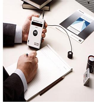
Fig. 4.19 Ejemplo de luxómetro.
