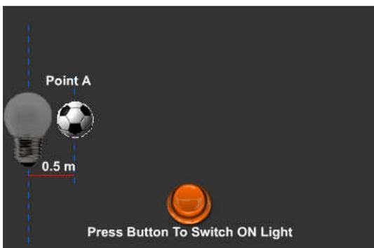
Por ejemplo, si una fuente de luz puntual emite una intensidad luminosa de 1.200 cd en dirección perpendicular a una superficie a una distancia de 3 metros, la iluminancia E en el punto en que la luz toca la superficie será 1.200 / 3<sup>2</sup> = 133 lux. Si la superficie está a una distancia de 6 metros de la fuente de luz, la iluminancia será: 1.200 / 6<sup>2</sup> = 33 lux.
