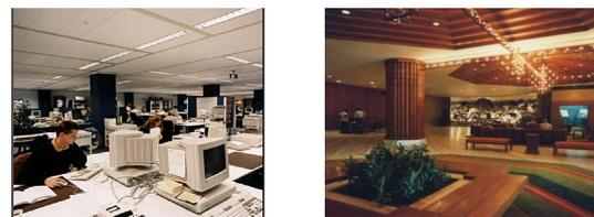
Fig. 6.11 Espacios iluminados con lámparas de alta temperatura de color (izquierda) y lámparas de baja temperatura de color (derecha), con distintos aspectos y ambientes.
