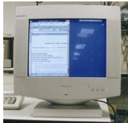
Fig. 8.5 Pantalla de ordenador de poca calidad que, especialmente con un fondo oscuro, da lugar a molestos reflejos.
