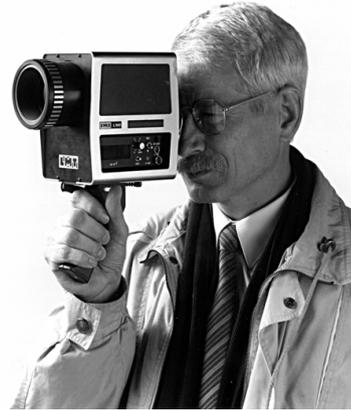
Fig. 4.22 Ejemplo de un luminancímetro de mano.
