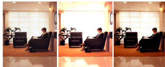
Fig. 5.14a De izquierda a derecha: 1. Contraste de luminancia: demasiado bajas. 2. Contraste de luminancia: demasiado altas 3. Contraste de luminancia: correctamente equilibrada
