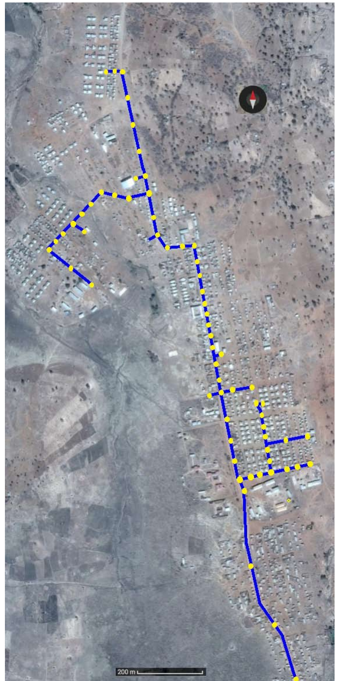
Ubicación de la red de alumbrado público y los puntos de luz instalados. Fuente: GoogleMaps modificado
