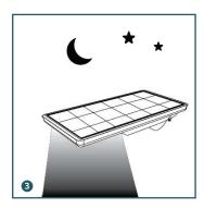
El panel solar detecta la oscuridad y la luminaria se enciende durante la noche automáticamente.
