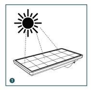
Ajuste la orientación del panel solar a la trayectoria del sol para cargar la batería por completo.
