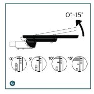
Con las marcas inteligentes de montaje en báculos, el ángulo se puede ajustar fácilmente.
