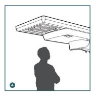
El sensor PIR detecta el movimiento del cuerpo humano para cambiar los niveles de iluminación.
