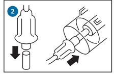
Conecte el tubo al compresor y al recipiente para el medicamento.
