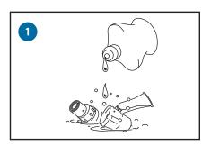
Coloque las piezas (excepto el tubo) en agua con 2 a 3 gotas de detergente líquido.
