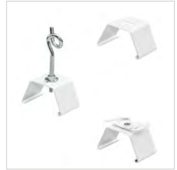
Optional zu bestellende Montagebügel: Kettenabhängler, Montagebügel für direkte Deckenbefestigung oder Montagebügel für Deckensysteme mit sichtbarem T-Tragprofil
