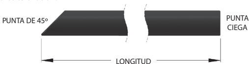
Figura 1: Configuración de la punta de la vaina del dilatador VisiSheath
