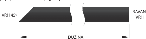
Slika 1: Konfiguracija vrha VisiSheath dilatacionog uvodnika
