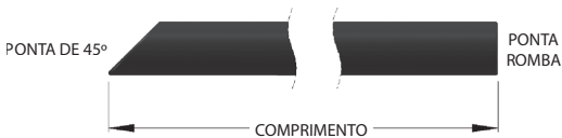
Figura 1: Configuração de pontas da Bainha Dilatadora VisiSheath
