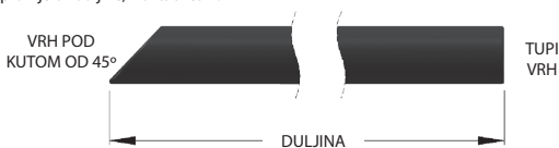
Slika 1: Oblik vrha dilatacijske ovojnice VisiSheath
