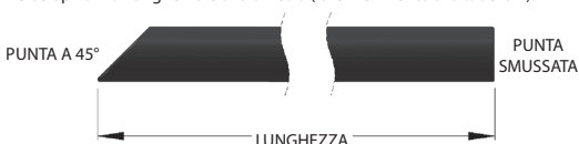
Figura 1: configurazione della punta dell'introduttore dilatatore VisiSheath
