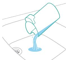
8 Gießen Sie die restliche Reinigungsflüssigkeit aus dem Frischwasserbehälter in das Spülbecken.
