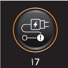
i7 | Das falsche Ladegerät ist angeschlossen.               | Laden Sie das Gerät nur mit dem mitgelieferten Adapter auf. Verwenden Sie nur den 34-V-Adapter S036-1A340100HE. Die entsprechende Adapternummer finden Sie auf dem Adapter.                                      |
