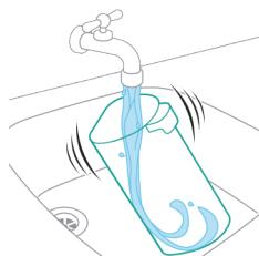
**17** Reinigen Sie den Schmutzwasserbehälter unter fließendem Wasser.
