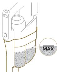
Leeren Sie den Staubbehälter regelmäßig, und achten Sie darauf, dass der Schmutz die Markierung MAX nicht überschreitet. Dadurch wird verhindert, dass der Filter vorzeitig verstopt wird.
