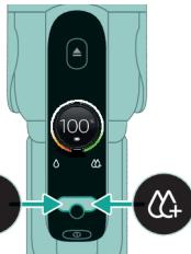
**10** Verwenden Sie die Tasten links ⚠ und rechts ⚠, um zwischen den verschiedenen Leistungseinstellungen zu wählen.
