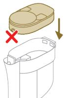
**9** Setzen Sie das Filtergehäuse mitsamt Schaumstofffilter wieder in den Staubbehälter ein.
