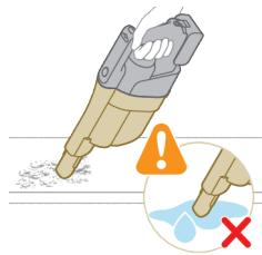
Sie können das Handstück ohne die Düse und ohne Saugrohr verwenden, um kleine Flecken von Staub und Schmutz (wie z. B. von verstreuten Brotkrümeln) zu befreien, oder um Treppen und Regale zu reinigen.
