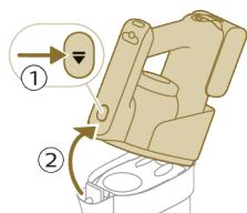
**1** Drücken Sie die Entriegelungstaste (1), um das 3-in-1-Handstück vom Staubbehälter zu lösen, und heben Sie dann das 3-in-1-Handstück vom Gerät (2) ab.
