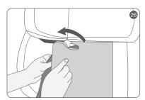
③.将安全带放在儿童汽车座椅后面的垫子下面。(如图26)
