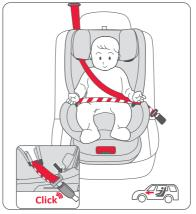
1.安装方式:三点式安全带+fix
