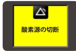
消毒中に酸素が検出された場合は、「酸素源の切り離しを促す、酸素源の切断メッセージ」アラームが発報され消毒サイクルが停止します。
