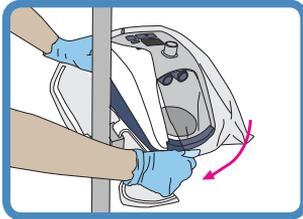
識別記録がはっきり見えるように記録部分がディスプレイとボタンの上になるようにAIRVO 2 を洗浄保管用カバーで包んでください
