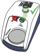
この洗浄ステップは、消毒サイクルを行なう前に排気エルボー（右側のチャンバーポートと熱線入り回路接続ポートの間）から残留物を除去することを目的としています。消毒サイクルの効率を確保するため、この洗浄ステップを最初に行なうことが重要です。さらに、ユニットの他の表面を清掃することは重要です。
