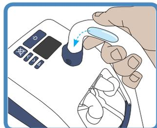
熱線入り回路に過剰な結露水が溜る場合、チューブの患者側を持ち上げて結露水が給水チャンバーに戻るようしてください。
