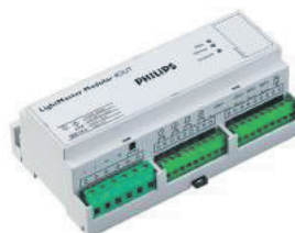
DIN-railunit met 4 afzonderlijke uitgangen (schakelen en regelen via 1-10 V) die elk een belasting van 5 A kunnen schakelen voor het regelen van armaturen, hetzij direct of via schakelaars in de schakelkast voor het schakelen van hogere verlichtingsbelastingen.
