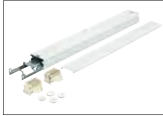
LL500Z CM L400 *) Virransyöttöpaketti valaisinkiskolle. Syöttö kahden kiskon välistä. Sisältää osat: profiili 400 mm, peitekansi, syöttöliittimet 2 kpl, päätykannet 2kpl. Profilissa kaksi läpivientiaihiota.
