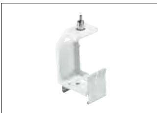
LL500Z CDS *) Vaijeriripustuskiinnike kitkalukolla 2 mm:n vaijerille kaapelikouruasennusta varten 1 kpl. Kiinnikkeellä voidaan ripustaa valaisinkisko sekä sen päälle tuleva kaapelikouru.
