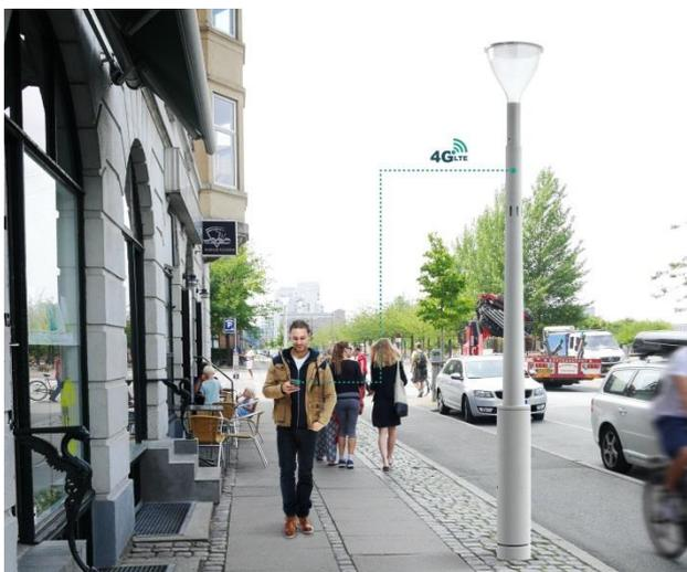
La forme du mât Philips lightpole site ressemble à celle des luminaires publics utilisés en Europe, ce qui lui permet de se fondre dans le paysage tout en augmentant la couverture du réseau LTE<sup>[1]</sup>/4G. Le mât doit sa taille compacte aux antennes développées dans le cadre d'une collaboration intégrées aux lampadaires et aux petites radios cellulaires d'extérieur d'Ericsson.
