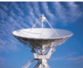
Radioteleskope sind in der Lage, elektromagnetische Wellen mit einer Wellenlänge zwischen 3 cm und 6 m zu empfangen
