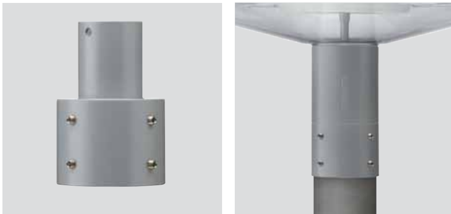
ZDP100 90/60 mm Adapter; für einen reibungslosen Übergang mit dem Aufsatzstück beträgt der äußere Durchmesser \varnothing 98 mm.
